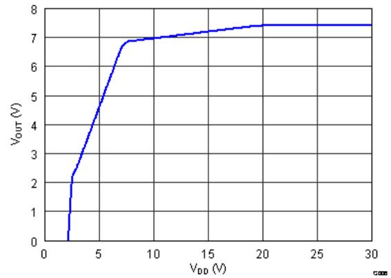
**Figure 9-7. V<sub>OUT</sub> vs. V<sub>DD</sub>**
